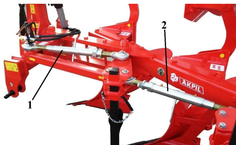
Rys.3. Śruby regulacyjne pługów serii MIX DUE.
