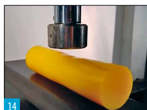
Amortyzator pod naciskiem 25 ton zachowuje swój kształt i właściwości
